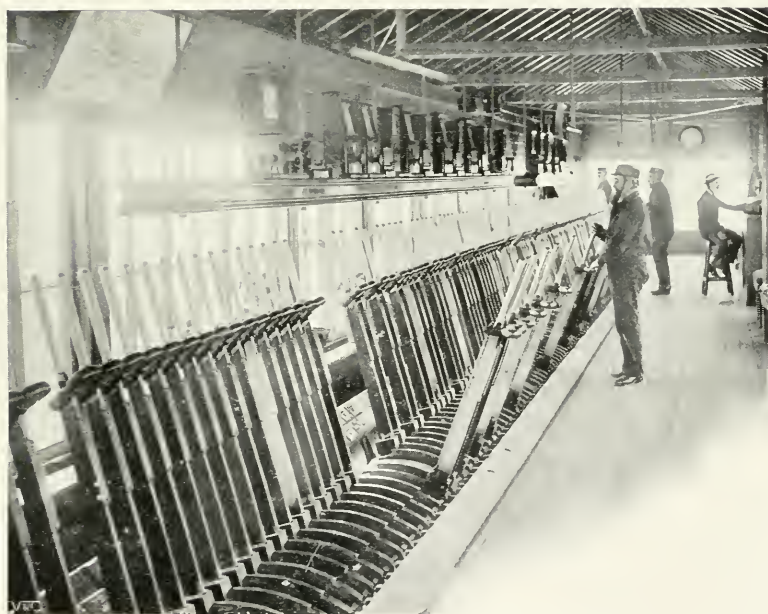
INTERIOR OF MANUAL SIGNAL-CABIN, L. AND N. W. R.
